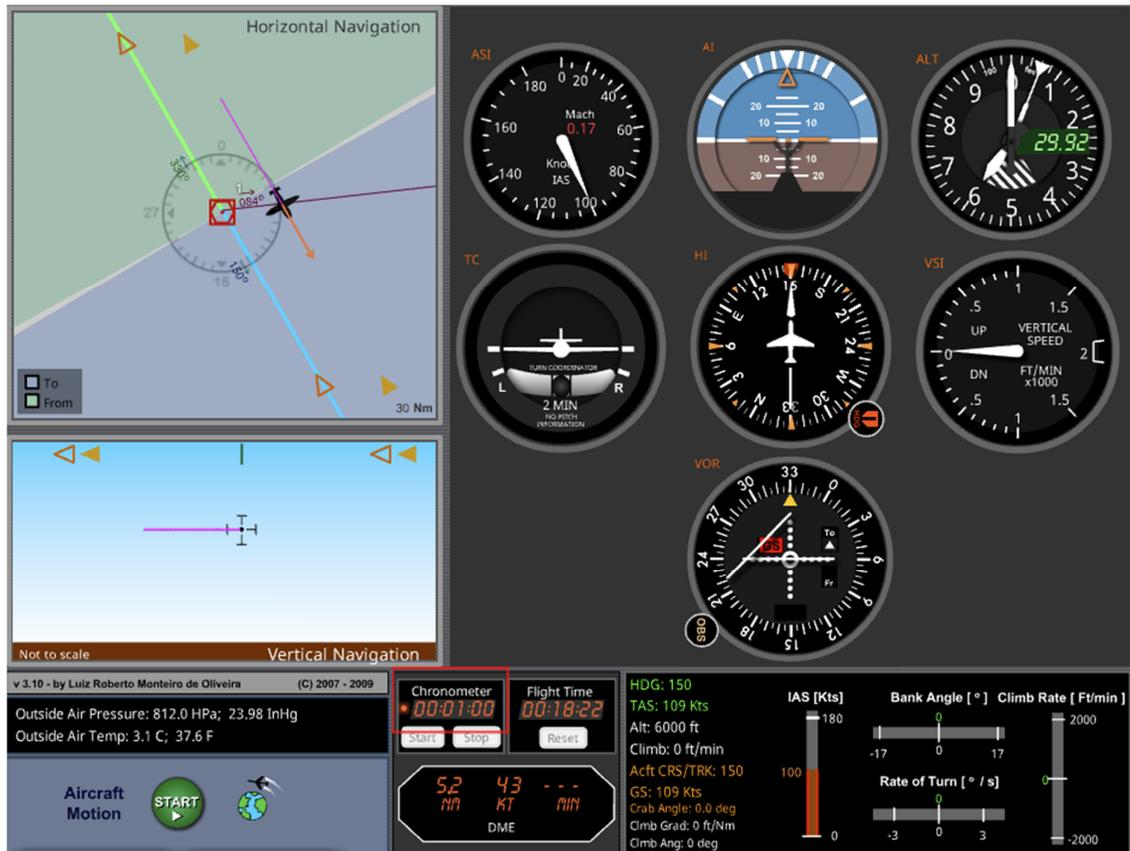
Luego del minuto, se debe girar por derecha, con el rumbo de interceptación ( $150^\circ + 90^\circ = 240^\circ$ ) hasta que el CDI quede centrado. Finalmente, con el CDI vivo o centrado, se gira por derecha, con rumbo opuesto al R-150, que sería ( $150 + 180 = 330$ ), en dirección a la estación. La cartilla del VOR le facilita este dato. El rumbo final siempre se lee en la parte superior de la cartilla.
