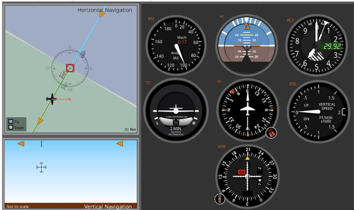
2. **Colocamos en la cartilla del VOR, con el OBS, el radial que nos pide el ATC**
