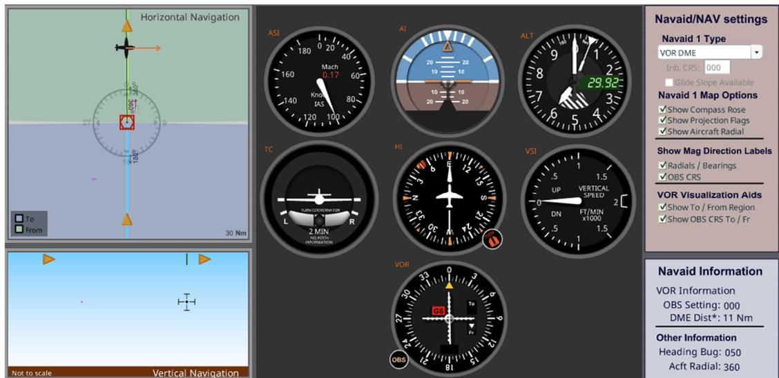
2. **Seteo del VOR.** Colocamos 040 en la parte inferior de la cartilla VOR (recordar que vamos a **INGRESAR** por el R-040, por esa razón se coloca en la parte inferior).
