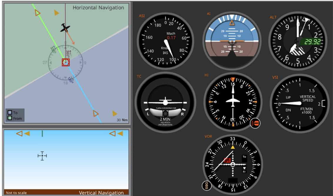
Volamos con rumbo  $150^\circ$  y posterior al cambio de sentido de FROM a TO, vamos a cronometrar un minuto, verificando que el R-150 esté seleccionado en la parte inferior, ya que va a realizarse un ingreso. Se vuela por un minuto, con la necesidad de alejarse de la estación.
