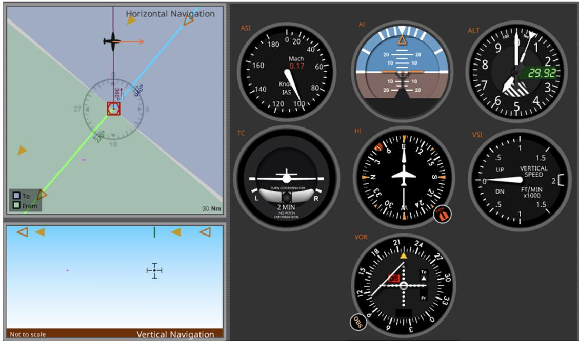
3. **Viraje e interceptación.** Determinamos hacia dónde vamos a virar viendo el Giro Direccional. Es decir, el R-040 se encuentra a la derecha del R-360 y a una distancia angular de 40 grados entre ambos. Por lo explicado, el giro va a ser por la derecha. El rumbo de interceptación va a ser  $40^\circ + 90^\circ = 130^\circ$  (ya que el rumbo  $130^\circ$  es perpendicular al R-040 y se trata de un INGRESO)
